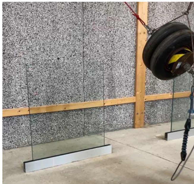
Foto 1: Opstilling til dynamisk test
